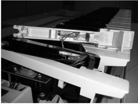
図 5 鍵盤に埋め込まれた振動モータ
