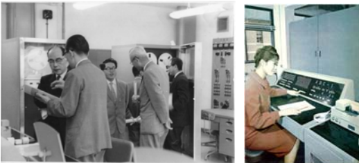
KDC-Iのコンソール：右側にあるのは、紙テープ読取装置と紙テープ。当時、プログラムは機械語で開発され、紙テープに穿孔された。
