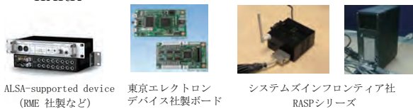
図 5 HARK で利用可能なマルチチャンネル A/D
