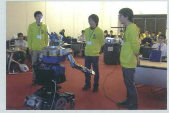
複数話者同時発話認識システムもHARK上で開発されている。ヒューマノイドロボットを使った実験でも、高い確率で聞き分けに成功した。写真は、2013年3月に京都大学で行われた3話者同時発話のデモの様子。
