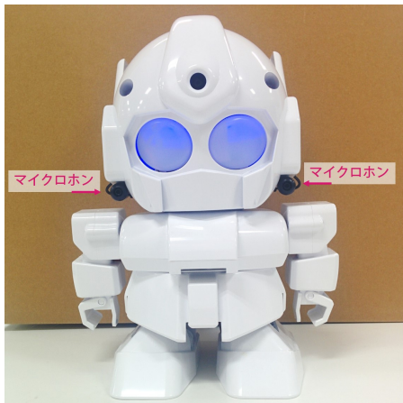
図 3: HARK-Binaural の応用例として使用したヒューマノイド。頭部量側面にマイクロホンを装着した。
