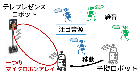
図 1: 複数ロボットの配置最適化の一例
