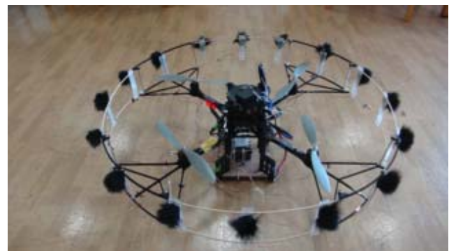
図 4: 実験で試用した UAV とマイクアレイ
