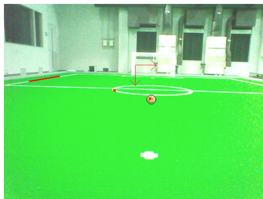
図 12: 3m 離れたボールの認識
