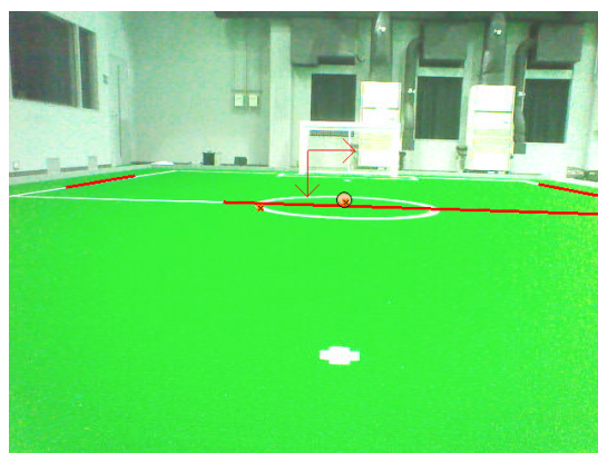
図 13: 4.5m 離れたボールの認識
