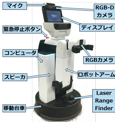
図 1: HSR の外観と主なデバイス
