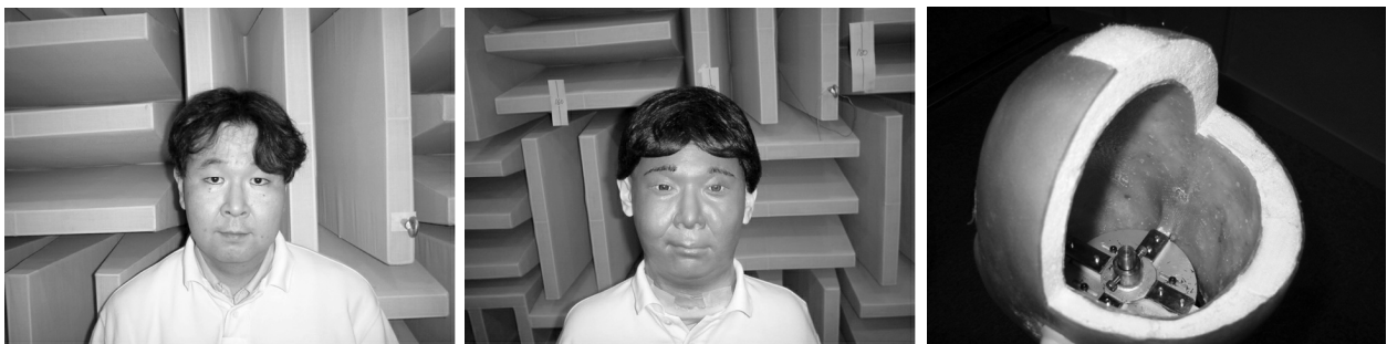
図4 モデル（左）とその頭部形状を再現したダミーヘッド（中）の一例。右はダミーヘッドの内部構造。FRP樹脂の骨格部分と発砲ポリウレタンの緩衝材と軟質ウレタンの表面の三層構造を成す。下の方に見えるのは、駆動機構との接続治具である。
