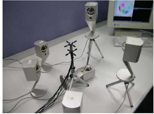
Figure 6: 3次元に配置された6音源と4cm立方体の各頂点に配置された8個のマイク
