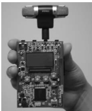
Figure 8: 開発したリアルタイム BSS モジュール
