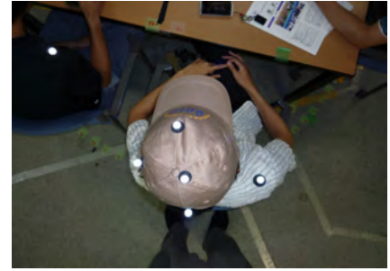
(c) MAC3D システムマーカー, 帽子と肩にあ る白い円状物がマーカーである.
